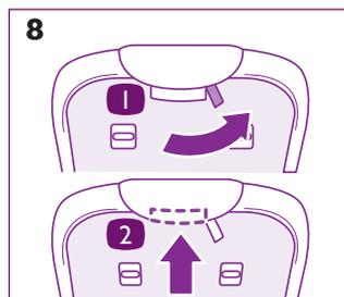
Faites pivoter le taquet de dégagement vers l'extérieur, puis enfoncez le bouton d'inclinaison complètement (**Figure 8**). Tout en enfonçant le bouton d'inclinaison et quand le taquet est orienté vers l'extérieur, soulevez le siège du cadre (**Figure 8a**).
