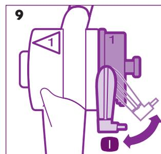
Pour enlever les adaptateurs, faites pivoter les taquets gris et faites glisser les adaptateurs pour les enlever (**Figures 9-9a**).
