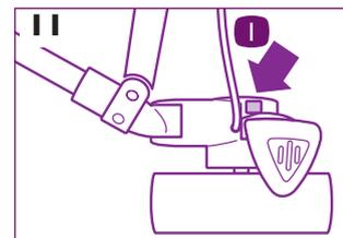
Appuyez sur le bouton de dégagement et tirez la roue avant hors du cadre (Figure 11a).
