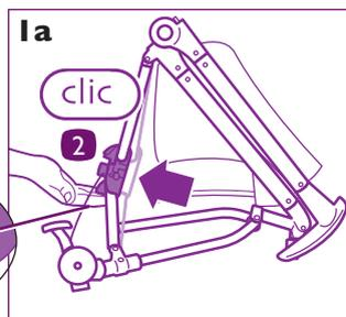
Soulevez la partie supérieure du siège de la poussette comme montré jusqu'à ce qu'elle s'enclenche en place (Figure 1b). Conseil: Tout en soulevant la partie supérieure du siège, maintenez la partie inférieure du siège.
