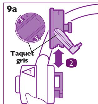
Pour rattacher les adaptateurs de siège, déployez le cadre de la poussette, soulevez le taquet gris pour exposer les fentes, alignez les fentes avec le cadre, faites glisser les adaptateurs à l'intérieur et poussez les taquets gris vers le bas (**Figures 9-9a**).
